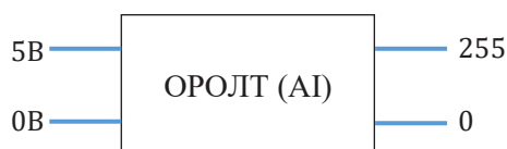
Зураг 3.3.3 Аналог - тоон дохионы хувиргалтын блок схем
